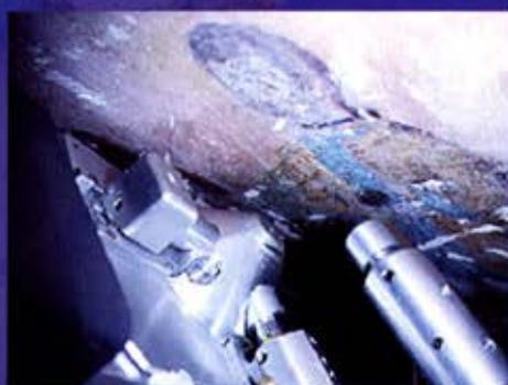
A través de la intersección de dos láseres, se selecciona el punto de análisis en las pinturas murales y posteriormente se excita mediante un haz de rayos X (área de radio = 1mm). La Fluorescencia de Rayos X producida en el área irradiada es detectada por el detector y el espectro FRX se registra en la computadora del Art-FRX.
